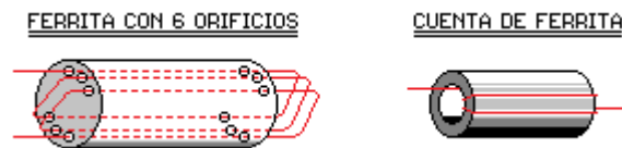
Figura 20: Ejemplos de núcleos de ferrita empleados para implementar pequeños inductores, choques de radio-frecuencia y circuitos anti-parásitos.
