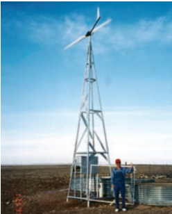
Sitio—Granja cercana a Wheeler, Texas Capacidad—1 kilowatt Fabricante—Southwest WindPower Fotografía—Elliott Bayly
