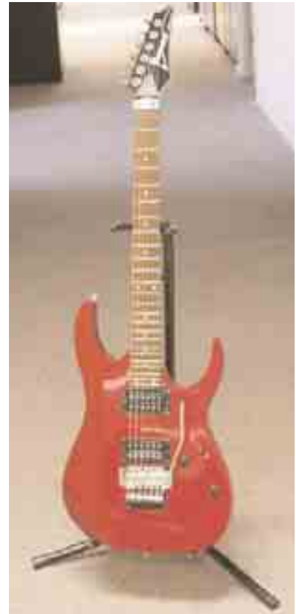
La guitarra eléctrica funciona según la ley de Faraday. La cuerda al vibrar induce una f.e.m. en una bobina.
