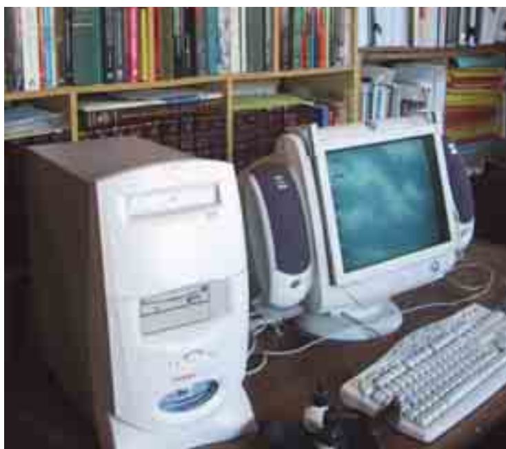
La cubierta metálica de una C.P.U. (unidad central de procesos) actúa como jaula de Faraday.
